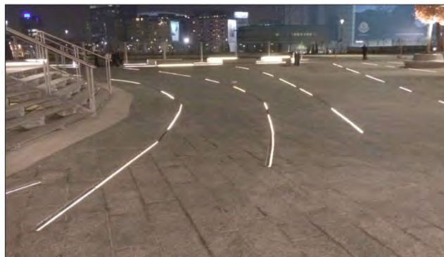
Esempio di canaletta drenante con segnalazione di percorso luminosa (Piazza Gae Aulenti, MI) - tipo: Aco drain Multiline Linea Luce
